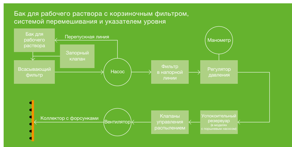
Базовая схема движения жидкости в вентиляторном опрыскивателе
