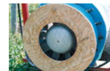
Использование деревянного диска для уменьшения объема воздуха, поступающего в воздухозаборник вентилятора
