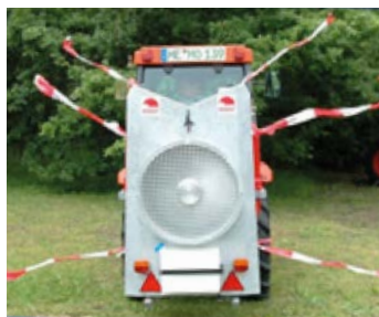
Использование лент для проверки воздушного потока
