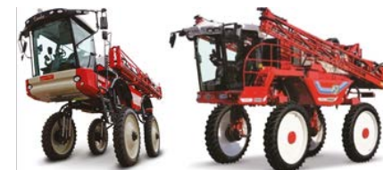
Высокий дорожный просвет на опрыскивателях Agrifac Condor (слева) и Bargam Grimac (справа)
