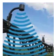
Установленный на штанге ультразвуковой датчик почвы/культуры
