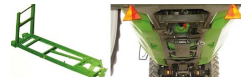
Шасси и вид на прицепной опрыскиватель снизу (Источник: Теслома)
