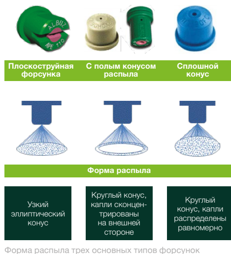
Форма распыла трех основных типов форсунок
