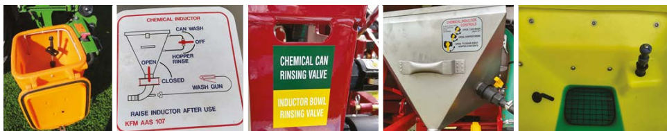
Примеры баков-смесителей на штанговых опрыскивателях
