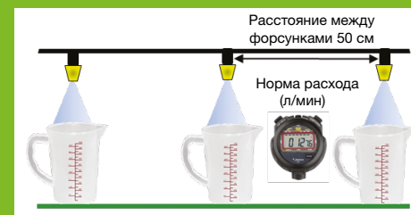
Калибровка с помощью мерной емкости
