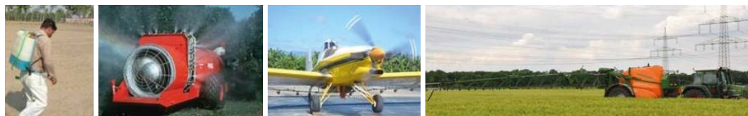
Альтернативные методы опрыскивания — ранцевый опрыскиватель, вентиляторный опрыскиватель и авиационно-химическая обработка
