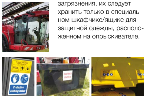
СИЗ можно хранить на опрыскивателе в отдельных шкафчиках для чистой и использованной защитной одежды
