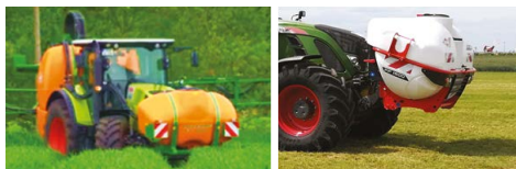
Варианты расположения навесных баков для рабочего раствора
