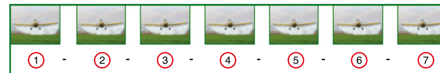
Рис. 67. Испытания для определения рисунка распределения капель — раствор распыляется над семью точками отбора проб
