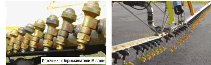
Рис. 34. Штанги опрыскивателя — цилиндрические с гидравлическими форсунками (слева), обтекаемые с форсунками CP® (справа)
