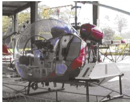
Рис. 20. Вертолет Bell 204/205 с резервуарами вьючного типа
