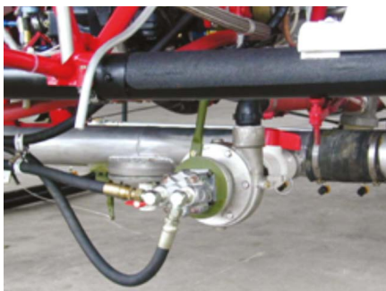
Рис. 21. Центробежный насос на вертолете Bell 204/205
