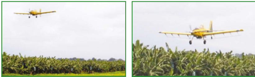
Рис. 49. Слишком большая (слева) и малая (справа) высота полета при авиаобработке банановой плантации
