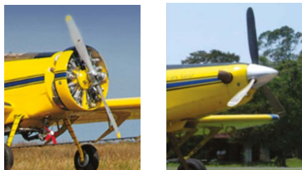
Рис. 3. Типы двигателей: звездобразный двигатель самолета Air Tractor® AT-401 В (слева) и газотурбинный двигатель самолета AT-602 (справа)
