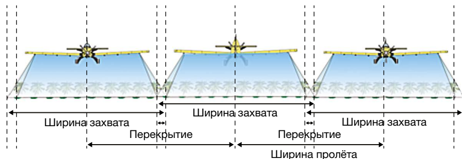
Рис. 46. Полная ширина захвата штанги и эффективная ширина захвата с учетом частичного перекрытия полос
