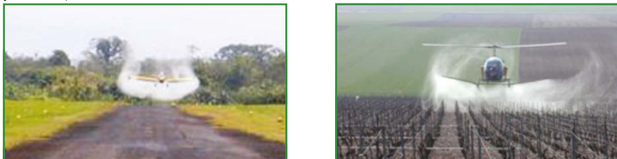
Рис. 53. Завихрения вокруг законцовок крыльев самолета и вертолета, выполняющих опрыскивание без насадок, уменьшающих снос
