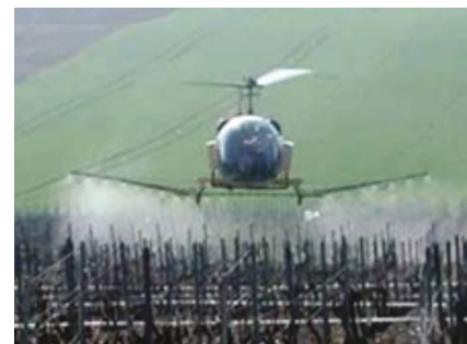
Рис. 4. Вертолет опрыскивает виноградник на склоне в Европе с использованием форсунок, уменьшающих снос распыла
