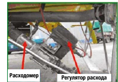
Рис. 39. Точное управление расходом с помощью расходомера и регулятора расхода
