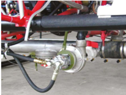
Рис. 21. Центробежный насос на вертолете Bell 204/205
