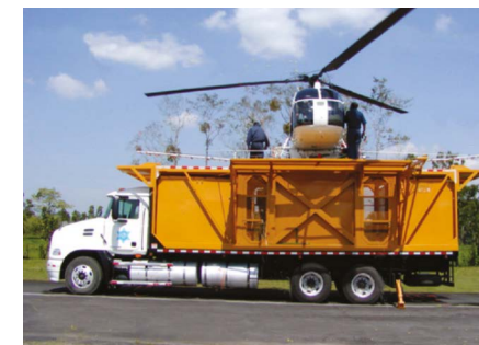
Рис. 5. Вертолет со вспомогательным транспортным средством, которое перевозит баковую смесь, топливо и служит посадочной площадкой
