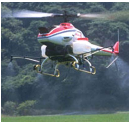
Рис. 2. Беспилотный вертолет Yamaha® RMAX, используемый для опрыскивания риса в Японии
