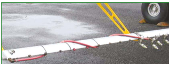
Рис. 55. Форсунки сняты с краев штанги для уменьшения влияния завихрений
