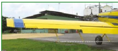
Рис. 54. Самолет Air Tractor AT-602, оснащенный опускаемой штангой с форсунками, длина которой не превышает 75 % размаха крыльев
