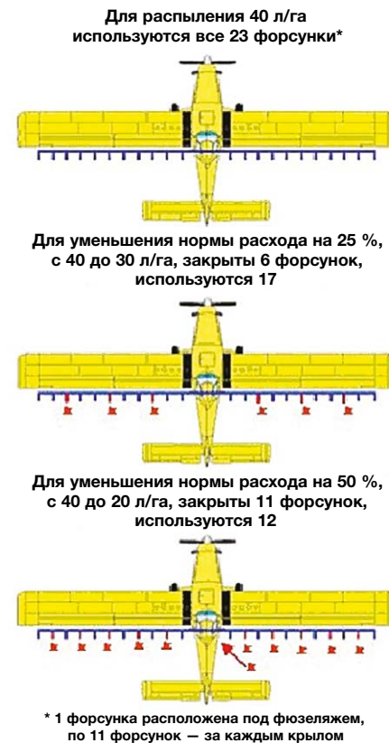
Рис. 42. Уменьшение объема рабочего раствора путем закрытия форсунок — пример снижения нормы расхода рабочего раствора с 40 до 30 и до 20 л/га
