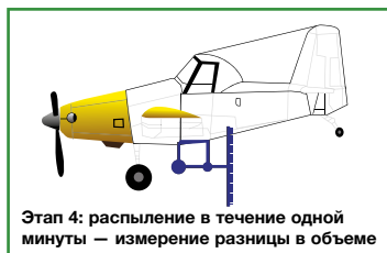
Рис. 61. Этап 4 — подтверждение нормы расхода рабочего раствора
