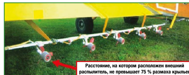
Рис. 56. Вращающиеся распылители должны устанавливаться в пределах 75 % размаха крыльев
