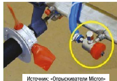
Рис. 36. Регулируемый дроссель изменяет норму расхода рабочего раствора на распылителе AU5000LD
