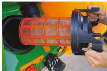
Всасывающий фильтр для штангового опрыскивателя
