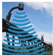
Установленный на штанге ультразвуковой датчик почвы/культуры
