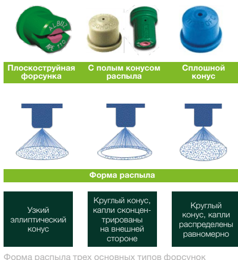
Форма распыла трех основных типов форсунок
