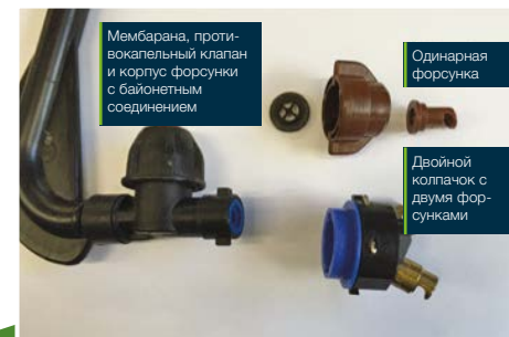
Drop-leg, оснащенная наконечником с одной и двумя форсунками
