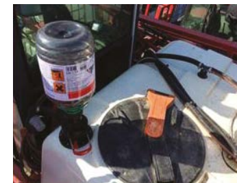
Закрытая система дозирования, установленная в верхней части бака для рабочего раствора
