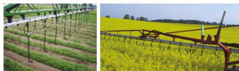
Drop-leg, используемые на штанговых опрыскивателях для обработки полевых культур
