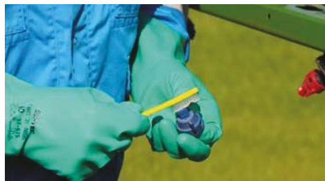
Очистка наконечника форсунки зубной щеткой.
