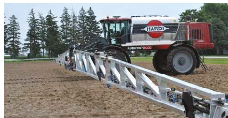
Большой самоходный опрыскиватель (Hardi Rubicon 9000) с баком для рабочего раствора объемом 9000 литров и штангой длиной 55 м
