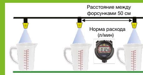
Калибровка с помощью мерной емкости
